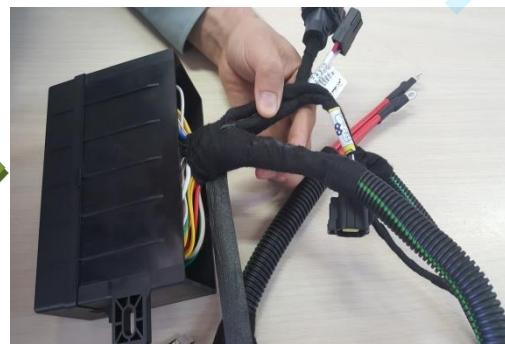
بازکاری جایگزینی فیوز تند سوز ۴۰ آمپری فن رادیاتور با نوع کندسوز
