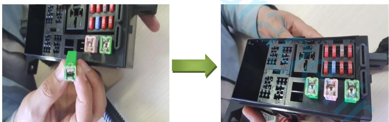
بازکاری جایگزینی فیوز قند سوز ۴۰ آمپری فن رادیاتور با نوع کندسوز
